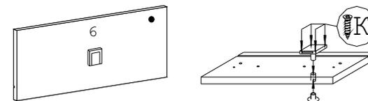
2. Привернуть ответную планку N на крышку тумбы напротив замка.
