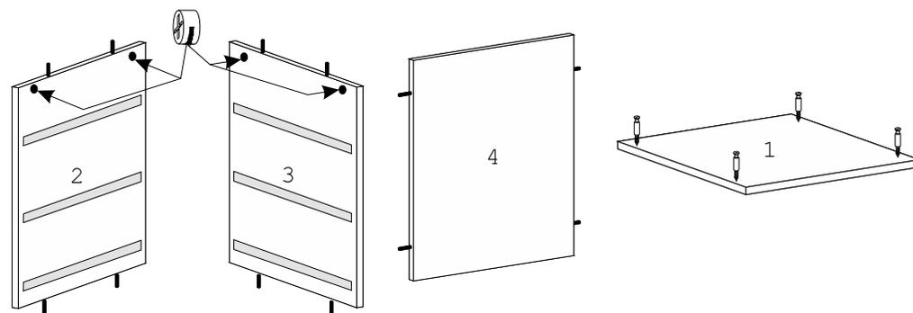
5. Соединить детали 2 и 3 с деталями 4 и 1, затянуть эксцентрики А по часовой стрелке до упора.
