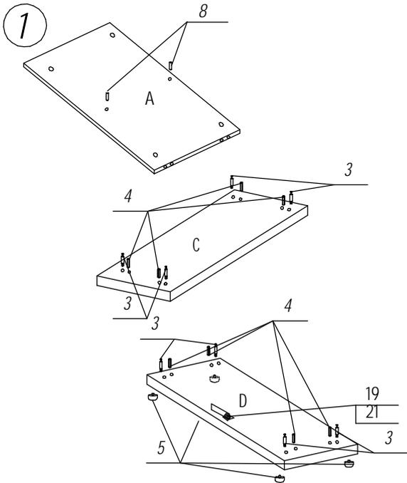
**1.** С помощью отвертки вкрутить в отверстия  $\varnothing 5$  мм венцев С и D винты эксцентрики (поз. 3).
