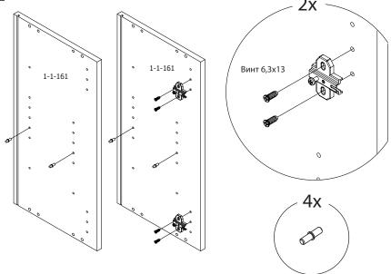
Способ установки планок петель для дверей: 1ДРс\_60-45 и 1ДРс\_60-50
