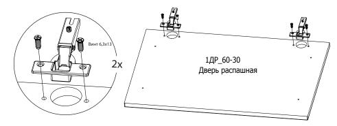
В большинстве моделей кухонь ДВЕРИ РАСПАШНЫЕ (ДР) являются универсальными. При этом перед установкой необходимо определить желаемое направление открывания двери и в зависимости от этого досверлить уже имеющиеся на ней глухие отверстия под ручку на твердой поверхности , во избежание вырывания передней пласти двери. Не универсальные ДВЕРИ РАСПАШНЫЕ (ДР) делятся на тип А и тип Б и имеют сквозные отверстия под ручки. При этом выбор типа двери определяется ее положением на каркасе модуля:
