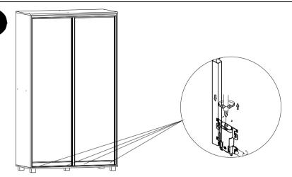
После установки, выровняйте двери регулировочным винтом на нижнем ролике. Отведите двери в крайнее положение и приклейте стопор на внутренней стороне верхнего трека.
