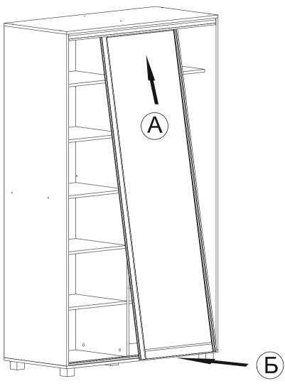
Верхний край двери вставьте в нужный паз верхнего трека, затем заведите нижний край прижимая дверь к верху вставьте нижний ролик в соответствующий паз нижнего трека.
