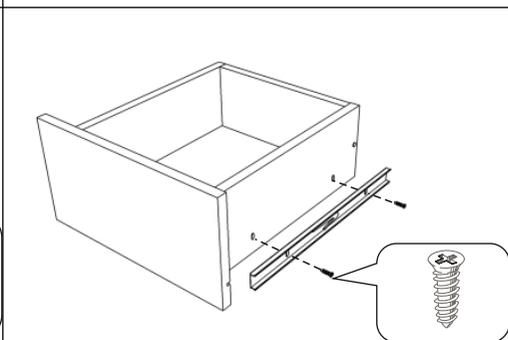
Установить ответную часть направляющей на боковую стойку ящика
