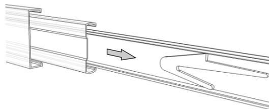
Вытащить узкую часть направляющей для установки ее на короб ящика
