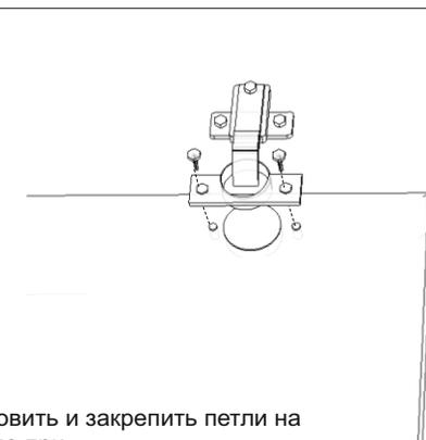
Установить и закрепить петли на фасаде при помощи саморезов 3,5x16
