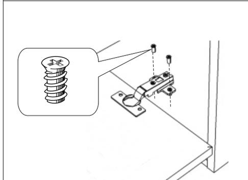
Закрепить ответную часть петли на корпусе тумбы при помощи евроинтов 6,3x13.
