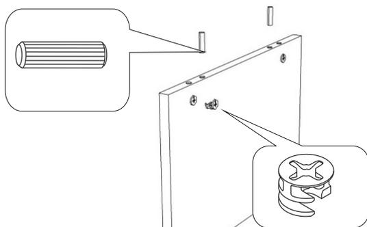
В отверстия Ø 15мм вставить эксцентрики Rastex 15 с направлением стрелки к ближайшему торцу, в глухие отверстия в торцах вставить шканты
