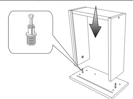
Соединить и закрепить между собой корпус и фасад ящика
