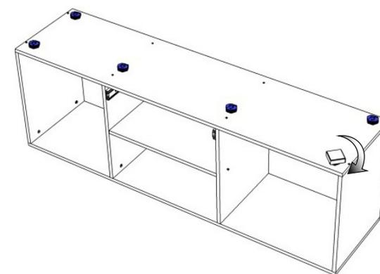
По разметке нанесенной на дно с помощью саморезов 3,5x16 установить ответные части опор, после вкрутить основные части
