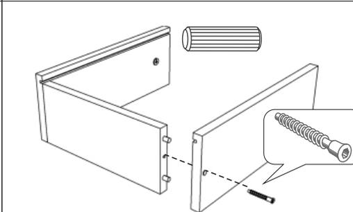
Соединить и закрепить между собой стойки и задник ящика
