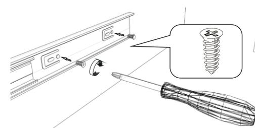
Установить ответную часть направляющей на внутренние стойки ⑤ ⑥
