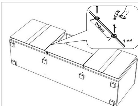
Закрепить задние стенки, стыки закрепить с помощью шайб
