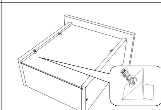
Выровнять диагонали короба ящика, закрепить дно ящика при помощи уголков с саморезами
