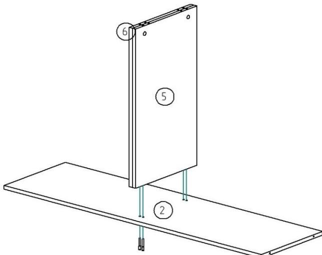
9. Соедините детали 5, 6 с деталью 2 с помощью винтов евро 7x50 мм.
