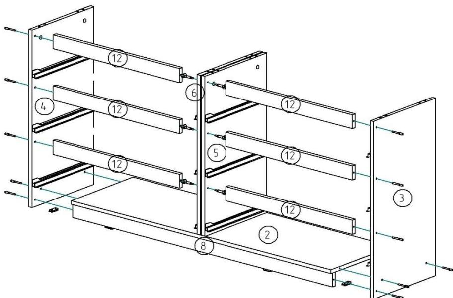
10. Установите на детали 3, 4, 8 подпятники с помощью гвоздей 2,0х25 мм.
