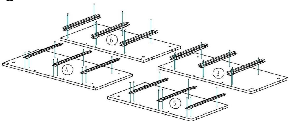
8. Установите на детали 3, 4, 5, 6 направляющие роликовые с помощью саморезов 3,5x16 мм.
