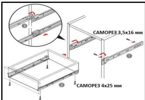
Рис. 1 Установка направляющих
