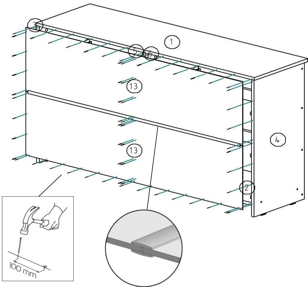
16. Закрепите детали 13 на каркасе комода с помощью гвоздей 2,0x25 мм, предварительно соединив детали 13 между собой бруском соединительным.
