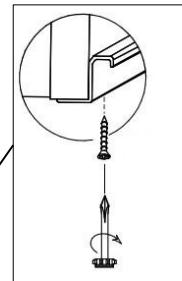
5. Закрепите направляющие роликовые с помощью саморезов 4x25 мм на деталях 10, 11.
