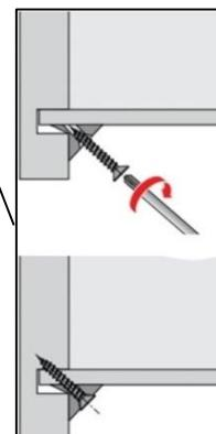
4. Установите деталь 14 в паз детали 7, закрепите ее с помощью гвоздей 2,0x25 мм на торцах деталей 9, 10, 11, а на деталь 7 закрепите уголками мебельными и саморезами 3,5x20 мм (по 3 уголка на каждый фасад).
