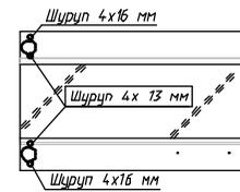
Во избежании трещины на стекле створки, необходима лента со стороны стекла закрепить шурупом 4x13 мм используя для отбортовки. Закручивать шуруп аккуратно неперпендикулярно. Створка устанавливается по месту.
