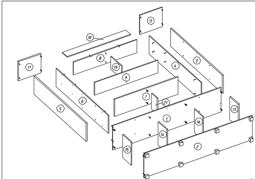
При сборке стенки необходимо сначала к детали поз.1 закрепить все вышестоящие детали и к детали поз.2 закрепить все вышестоящие детали поз.13, 14, 15, 16. А затем соединить под-борки на эксцентриковую стяжку.
